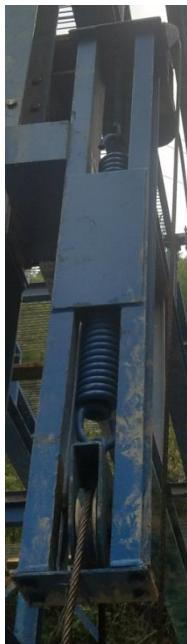
卷扬机注意事项1)：一、卷扬机使用时的注意事项： 1、卷筒上的钢丝绳应排列整齐，如发现重叠和斜绕时，应停机重新排列。严禁在转动中用手、脚拉踩 钢丝绳。钢丝绳不许完全放出，最少应保留三圈。 2、钢丝绳不许打结、扭绕，在一个节距内断线超过10%时，应予更换。 3、作业中，任何人不得跨越钢丝绳，物体（物件）提升后，操作人员不得离开卷扬机。休息时物件或吊笼应降至地面。 4、作业中，司机、信号员要同吊起物保持良好的可见度，司机与信号员应密切配合，服从信号统一指挥。 5、作业中如遇停电情况，应切断电源，将提升物降至地面。
